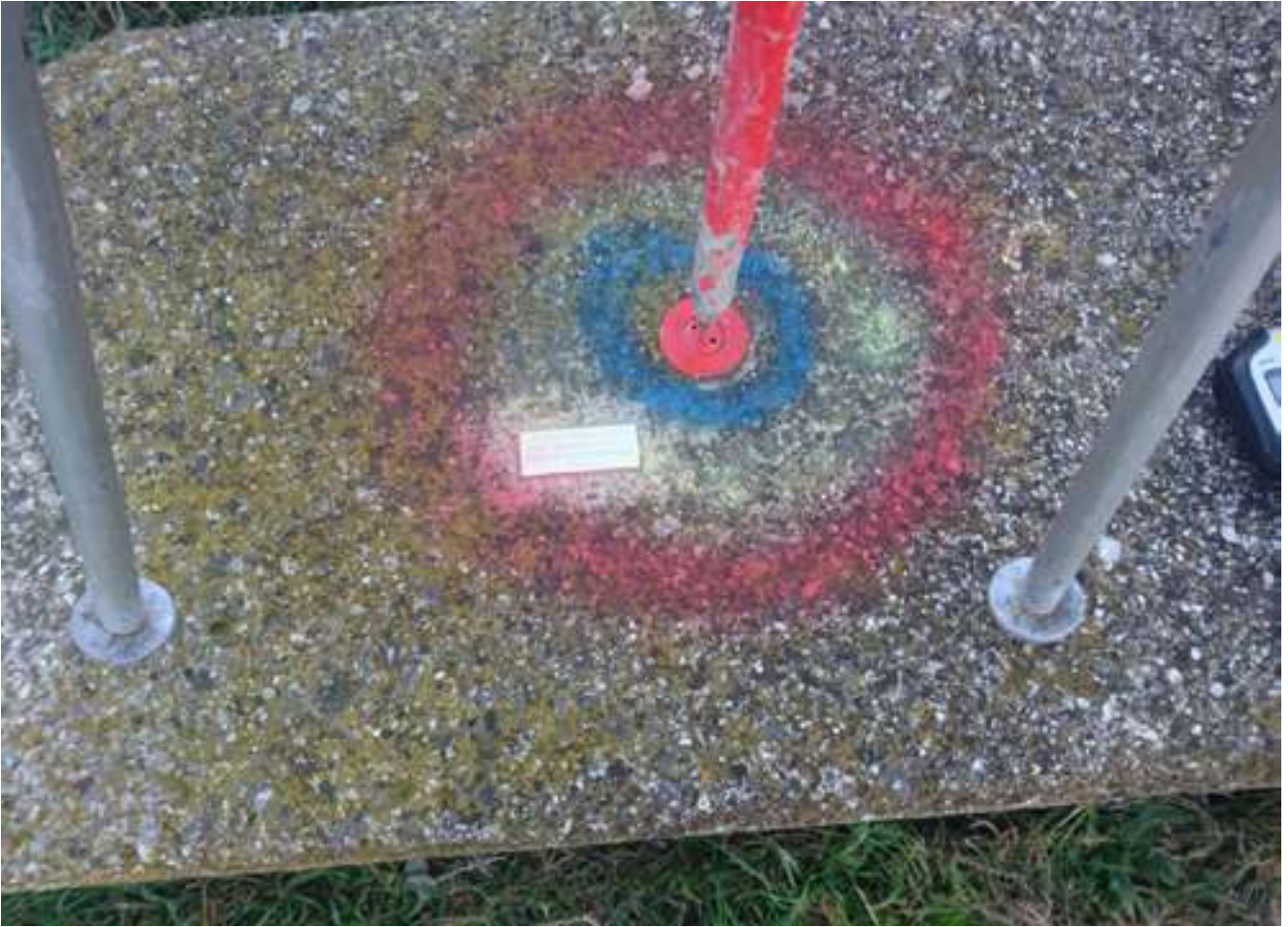
FIGURA 34 Rete Geodetica Costiera: vertice e targhetta.
