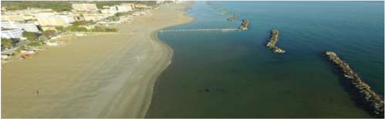
FIGURA 7 Torre Pedrera (Rimini): serie di scogliere parallele emerse (30 maggio 2018).
